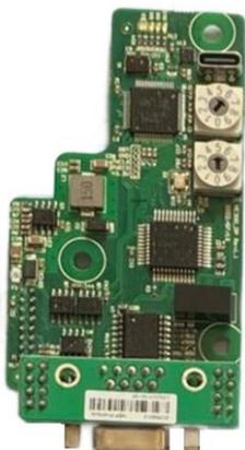
*Плата ProfiBUS для подключения к внешнему ПЛК Siemens*
