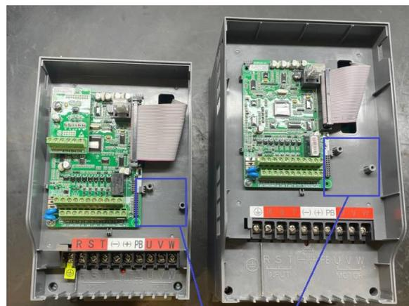
*Места крепления платы двумя винтами*
