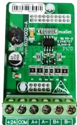
Плата для подключения энкодера на 24VDC (HTL)
