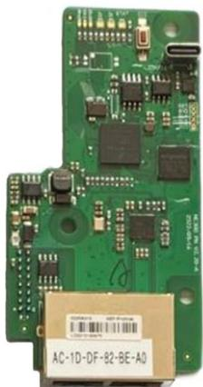
*Плата ProfiNET для подключения к внешнему ПЛК Siemens*
