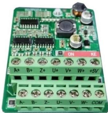
*Плата для подключения энкодера на 5VDC (TTL)*
