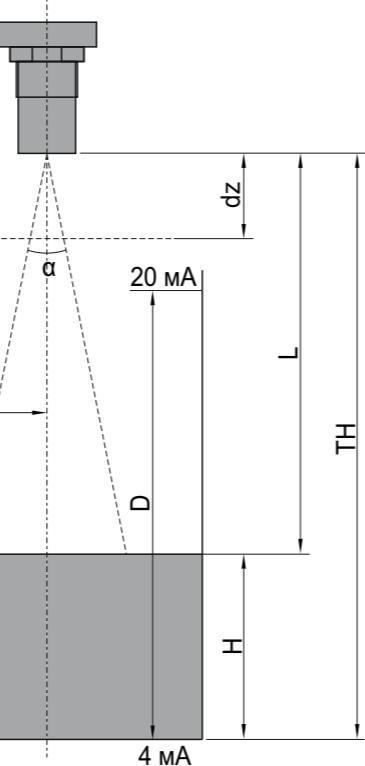
Для корректной работы датчика, обеспечивающей вывод показаний на ЖК-дисплей и соответствующего выходного тока, необходимо установить следующие параметры:
