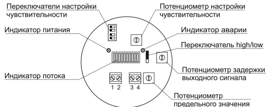
Подключите источник питания к винтовым клеммам 1 и 2. При подаче напряжения питания на клеммы устройства загорается «индикатор питания». Настройка режима выходного сигнала производится с помощью переключателя high/low.
