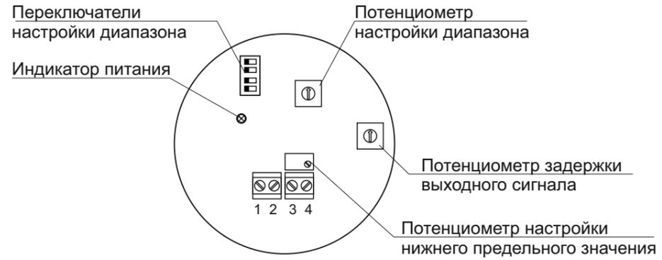
Подключите источник питания к винтовым клеммам 1 и 2. Для настройки датчика к клеммам 3 и 4 необходимо подключить токоизмерительный прибор (4...20мА). При подаче напряжения питания на клеммы устройства загорается «индикатор питания». Настройка нижнего предельного значения производится с помощью потенциометра «настройки нижнего предельного значения» по следующему алгоритму:
