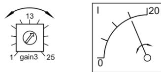
С помощью «потенциометра задержки выходного сигнала» регулируется сглаживание выходного сигнала, однако это ведет к задержке времени его реакции. Диапазон от 0 до 120 секунд\*\*. Выходной сигнал в данном случае представляет собой усредненное значение для выбранного промежутка времени.
