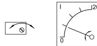
Для настройки диапазона измерения применяются «переключатели настройки диапазона». В зависимости от положений переключателей и потенциометра, устройство реагирует на запыленность сильнее или слабее. Настройка диапазона измерения производится следующим образом:
