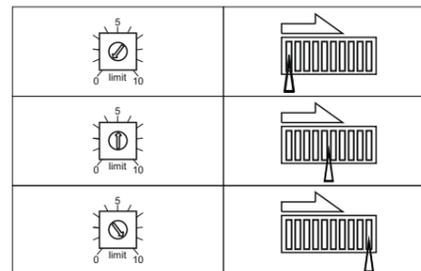
Адаптация выходного сигнала к интенсивности потока производится «переключателями настройки чувствительности» и «потенциометром настройки чувствительности».
