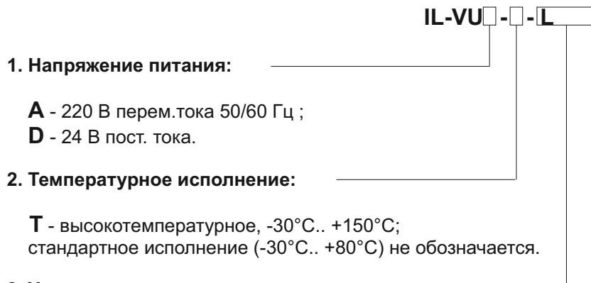
**L** - для версии с трубным удлинением значение удлинения в мм (стандартные исполнения 300, 500, 1000, 1500, 2000, иные длины по запросу);
