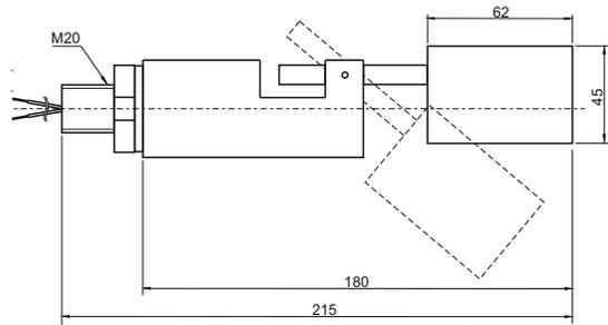
\* - Размеры для исполнений датчиков с поплавком из PVDF
