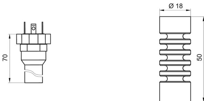
Корпус с измерительным преобразователем и разъемом DIN EN 175301-803 A (DIN 43650 A), 4-pin
